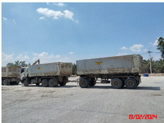
รูปที่ 11 การปิดคลุมกระบะรถบรรทุกแร่
